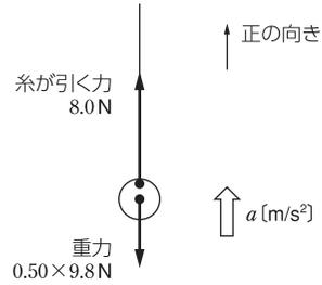
Step 2 鉛直上向きを正とし、小球の加速度を  $a [\text{m/s}^2]$  とする。
