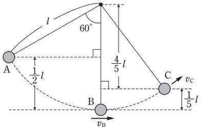
おもりの質量を  $m$  [kg] とし、点Bの高さを重力による位置エネルギーの基準水平面とすると、各点での運動エネルギーと重力による位置エネルギーは、表のようになる。
