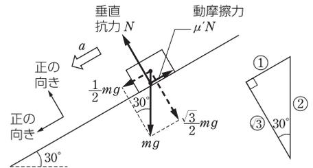
斜面に平行な方向について, 物体の運動方程式を立てると
