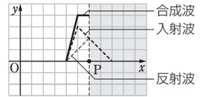
折り返した波が反射波である。合成波は、入射波と反射波を重ねあわせの原理に従って作図して求める。
