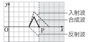
右側にまで進んだ波を上下反転し、さらにその波を固定端を軸に折り返した波が反射波である。
