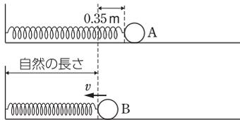
点Aと点Bを図のように定めると、各点での運動エネルギーと弾性力による位置エネルギーは、表のようになる。
