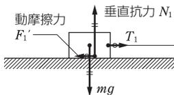
加速度の大きさを  $g$  [m/s<sup>2</sup>] とすると、一定の速さで移動しているの、 $T_1$  と動摩擦力  $F_1' (= \mu' N_1)$  の大きさは等しい。
