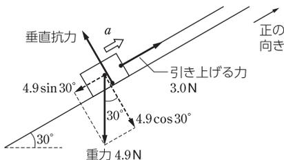
**Step 1** 小物体にはたらく力は、重力  $0.50 \times 9.8 = 4.9\text{N}$ , 垂直抗力, 引き上げる力  $3.0\text{N}$  の3つである。
