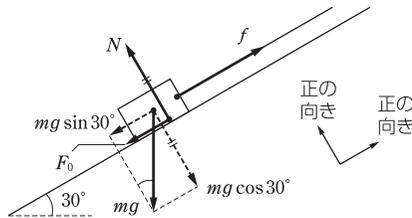
物体の質量を  $m$  [kg], 重力加速度の大きさを  $g$  [m/s<sup>2</sup>], 垂直抗力の大きさを  $N$  [N], 静止摩擦係数を  $\mu$ , 最大摩擦係数の大きさを  $F_0$  [N] とする。物体にはたらく力を斜面に平行な成分と斜面に垂直な成分とに分解する。物体が動きだす直前は物体にはたらく力がつりあっている。
