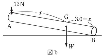
棒の重心の位置をA端より右に  $x$  [m] の所とし、棒の重さを  $W$  [N] とする。
