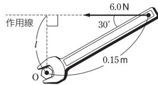
点Oのまわりの力のモーメント  $M[\text{N}\cdot\text{m}]$  は  $M=Fl=6.0 \times (0.15 \times \sin 30^\circ) = 0.45\text{N}\cdot\text{m}$
