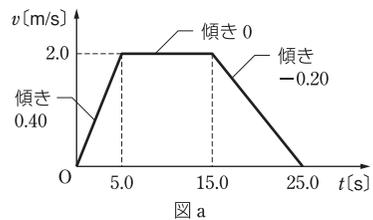
(3) 図 a で,  $0 \text{ s}$  から  $5.0 \text{ s}$ ,  $15.0 \text{ s}$ ,  $25.0 \text{ s}$  までの  $t$  軸とによって囲まれた部分の面積が位置  $x_1, x_2, x_3 \text{ [m]}$  である。
