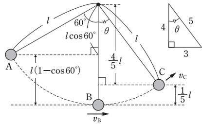
おもりの質量を  $m \text{ [kg]}$ 、点Bの高さを重力による位置エネルギーの基準水平面とする。点Aと点Bの間での力学的エネルギー保存則より
