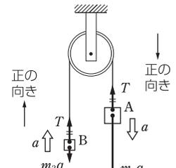
**Step 1** 糸がAを引く力とBを引く力の大きさは、同じである。A, Bにはたらく力は図のようになる。
